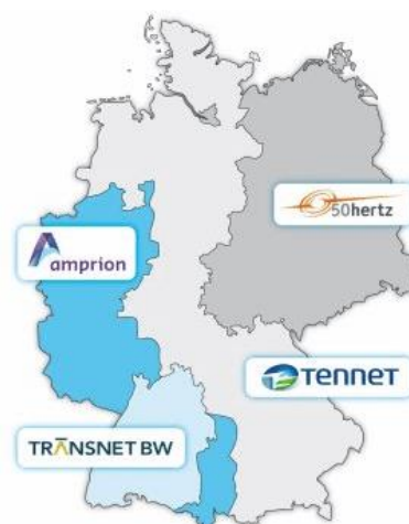
Abbildung 74: Regelzonen der Übertragungsnetzbetreiber (vgl. Speckamp 2016)
